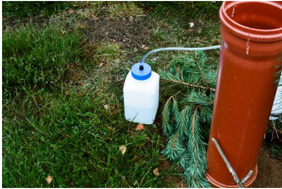
Abb.25: Regenwassersammler am Hiltruper See; Sammlung erfolgt über auf einen auf dem Rohr montierten Auffangtrichter mit Filter.
