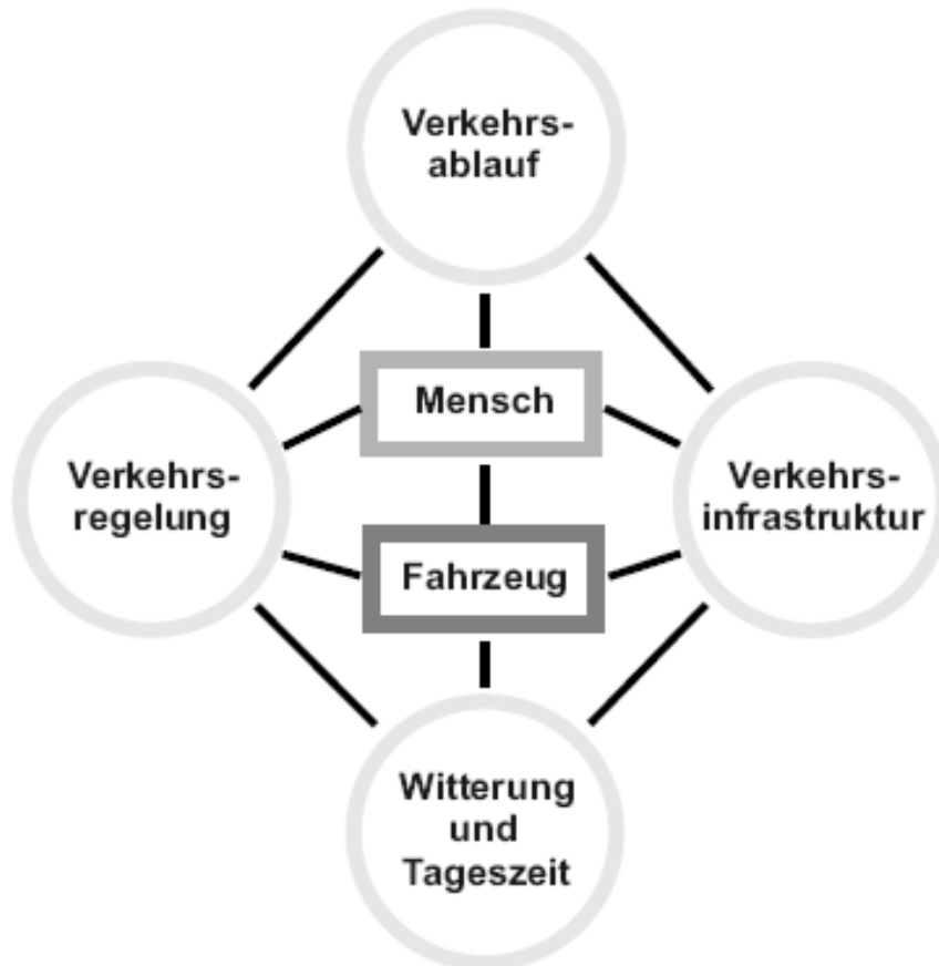
Bild 1: Regelkreis der wechselseitigen Einflussfaktoren der Verkehrssicherheit (Quelle: Amt für Stadtentwicklung, Stadtplanung und Verkehrsplanung, Dr. Oellers)
